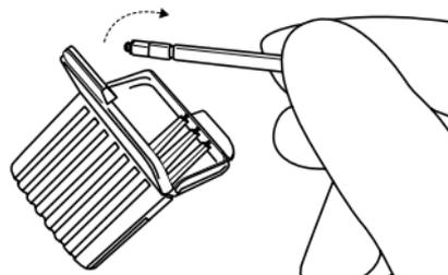
2. Откройте футляр с серными фильтрами и достаньте один из инструментов для их замены. У каждого инструмента есть маленький крючок (наконечник, используемый для извлечения) с одной стороны и новый серный фильтр с другой.
