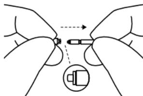
3. Вставьте наконечник инструмента, используемый для извлечения, в отработанный серный фильтр и вытяните инструмент, удерживая его прямо. Важно вытянуть инструмент, удерживая его прямо, а не под углом.
