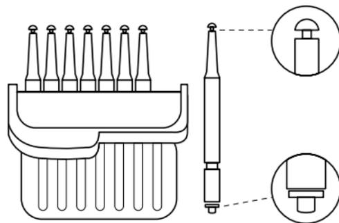
Коробка с 8 инструментами для замены серных фильтров. Инструмент для установки и извлечения серных фильтров выполняет две функции: извлечение отработанных серных фильтров и их замена на новые серные фильтры.
